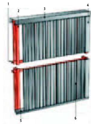
Il s'agit d'un système où les éléments en tôle d'acier nervurée sont juxtaposés par recouvrement. La ventilation et le drainage sont les deux notions à intégrer dans tout type de bardage.
