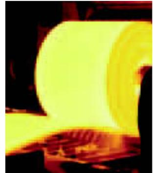
Laminage à chaud d'une bobine d'acier.
