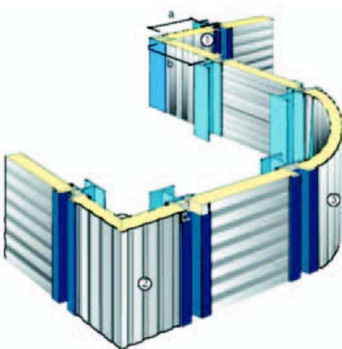
Ci-contre : assemblage de panneaux-sandwich sur une ossature métallique
