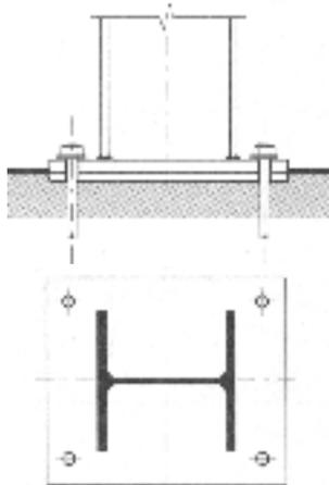
L'articulation simplifie le calcul des structures car elle empêche la transmission des moments de flexion (valeur nulle du moment à l'articulation), facilite leur montage et permet aux structures de mieux prendre en compte les petits mouvements (dilatations, tassements différentiels...). On classe dans la catégorie des articulations les appuis de poteaux de faible section comportant une semelle et deux boulons de scellement.
