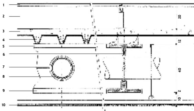
Ci-contre, coupe de principe sur un plancher mixte - acier-béton avec bac acier -, faux plafond et plafond suspendu. Les réseaux passent dans le plenum à travers les poutrelles alvéolaires.
