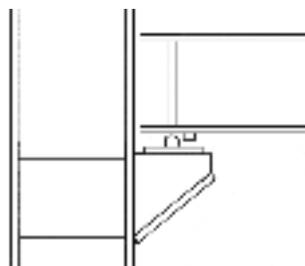
**Appui simple à dilatation poutre sur poteau.**
