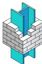
Protection par écran : poteau intégré à la maçonnerie.
