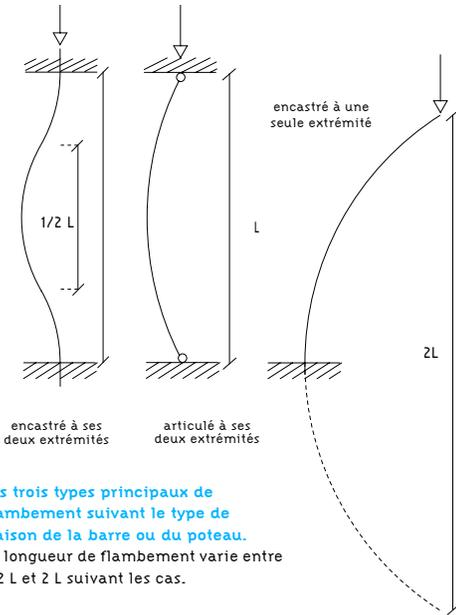
Les trois types principaux de flambement suivant le type de liaison de la barre ou du poteau. La longueur de flambement varie entre  $1/2 L$  et  $2 L$  suivant les cas.
