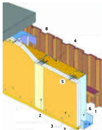
Les plaques de plâtre peuvent être remplacées par des panneaux de bois de particules ou par des vitrages avec des profils à froid comme structure.
