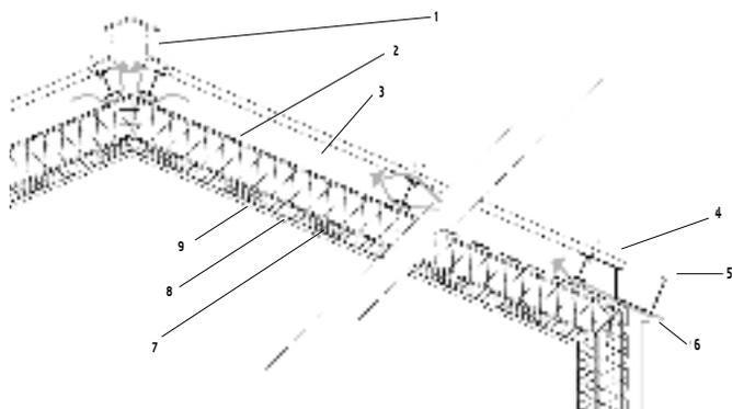
Ci-contre, coupe schématique d'une toiture froide avec vide d'air ventilé.
