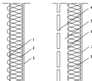
Principes de façade étanche (à gauche) et de façade à parement extérieur non étanche (à droite).
