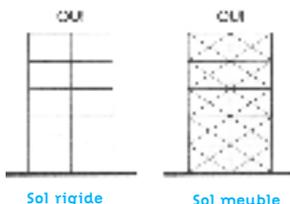
Choix du système porteur : ossature flexible sur sol rigide (à gauche) ; ossature rigide sur sol meuble (à droite).
