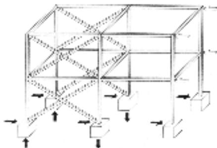
**Système de stabilité.** Les treillis sont constitués de barres qui forment des triangles. Les axes des barres concourantes au même nœud doivent se couper en un seul point. Cf. Bibliographie [10, p.228].
