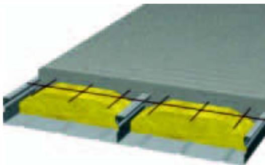
Ci-contre : système de plancher préfabriqué en usine de type Cofradal 200 composé d'un double bac acier portant un isolant acoustique et thermique et une dalle en béton armé.
