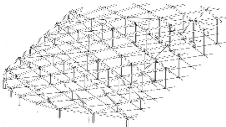
Axonométrie de la double nappe de la toiture de la patinoire de Grenoble et détail d'un nœud d'assemblage montrant le poinçon comprimé entre la nappe supérieure en tubes ronds et les tirants en partie basse.
