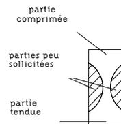
b) Section montrant les parties sollicitées en flexion. La poutre est peu sollicitée au voisinage de l'axe neutre
