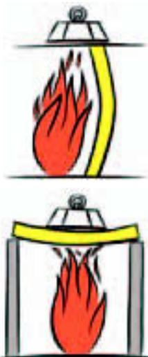
Stabilité au feu (SF) = (R). Temps en minutes durant lequel la résistance mécanique sous charge est assurée.
