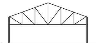
La limitation des déplacements sous l'action des forces horizontales conduit à l'augmentation des sections des poutres et des poteaux.
