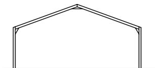
Ce sont des structures relativement coûteuses (environ 15 à 20 % de plus que des structures avec des contreventements), mais elles présentent l'avantage d'un moindre encombrement de l'espace et d'un usage plus flexible dans le temps en cas de changement d'affectation des locaux ou des immeubles.
