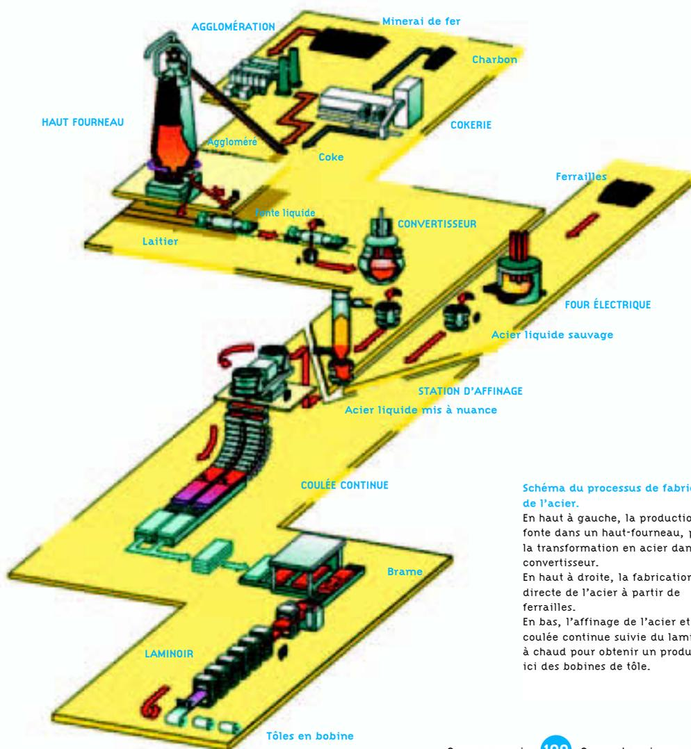
Schéma du processus de fabrication de l'acier.
