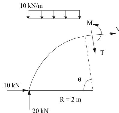
On calcule des valeurs intermédiaires de N, T et M et on Trace les diagrammes:
