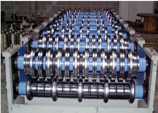
Train de laminage pour le façonnage des profilés métalliques
